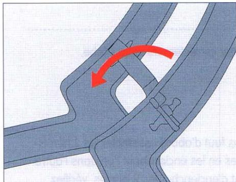
Pour monter le support rotatif, glissez les extrémités de la plus petite pièce grise dans les échancrures des deux grandes pièces grises qui servent de pieds. Tournez la petite pièce pour la mettre dans la bonne position.
