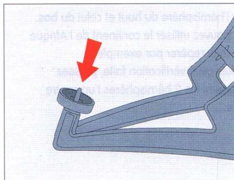
Posez le support sur la table et fixez les deux clips de manière à ce que les deux pointes se trouvent en vis-à-vis.
