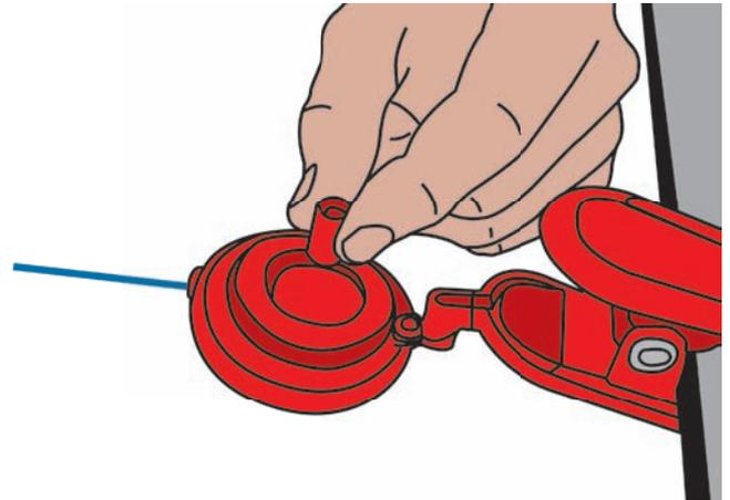
**9** Contrôlez le capteur : la languette noire doit être positionnée dans l'espace « détection de mouvement ». La languette ne doit pas toucher les parois du détecteur. Le fil-Laser et la languette doivent être légèrement en suspension.
