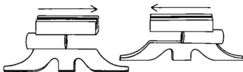
a) Assembler en poussant les pattes des papillons de telle sorte que les glissières pour les ailes soient l'une à côté de l'autre.
