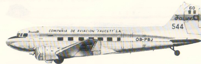
Douglas DC-3 de la Compañia de Aviacion Faucett S.A. Moteurs : deux moteurs à pistons en étoile Pratt & Whitney R-1830-92 de 1 200 CV et 14 cylindres. Envergure : 28,96 m. Longueur : 19,52 m. Surface alaire : 91,70 m 2 . Poids maximum au décollage : 11 430 kg. Vitesse de croisière caractéristique : 290 km/h à 3 000 m. Plafond opérationnel : 7 300 m. Rayon d'action avec charge marchande maximum de 2 270 kg : 1 060 km.
