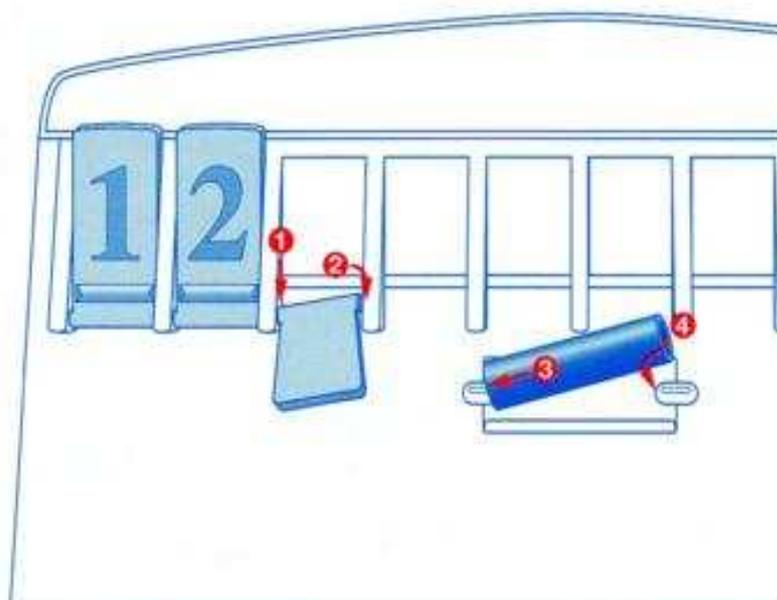
*Présenter le volet en position ouverte, légèrement incliné sur le côté.*
